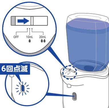
※スイッチを切り替えた時(OFF→10mL→20mL)赤い動作確認ランプが6回点滅します。使い始める際は点滅が終わってからコップをかざしてください。
