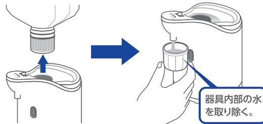
2. 「使用方法の5~6」に従って水を繰り返し出し、器具内部を洗浄します。(ボトル内の水がなくなるまで)
