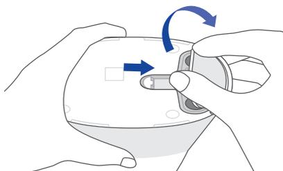
2. +の向きに注意して、単3アルカリ電池をセットし、再び電池カバーをセットしてください。
