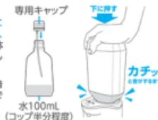
3. ボトルをまっすぐ上に引いて取り外し、スイッチを「20mL」に設定します。器具内部に水が残っているため、ノズルから水が出てこなくなるまで数回コップをかざしてください。
