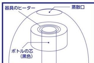
ボトルを器具下方よりカチッと音がするまで押し込んでセットしてください。その際、器具上部の蒸散口の中を見て、黒色の芯がリングヒーター(銀色)に触れないようにしてください。
