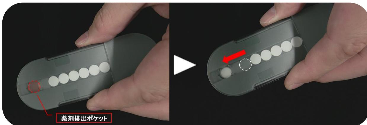
3. カートリッジリブを器具の「カートリッジリブ設置部」に合わせるようにして、器具にセットする。
