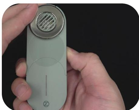
2. チャイルドロックを押し込みながらスイッチを下にスライドし LED が点灯するまで、1 秒以上押し込む。
